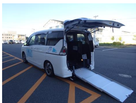
車いすスロープです
